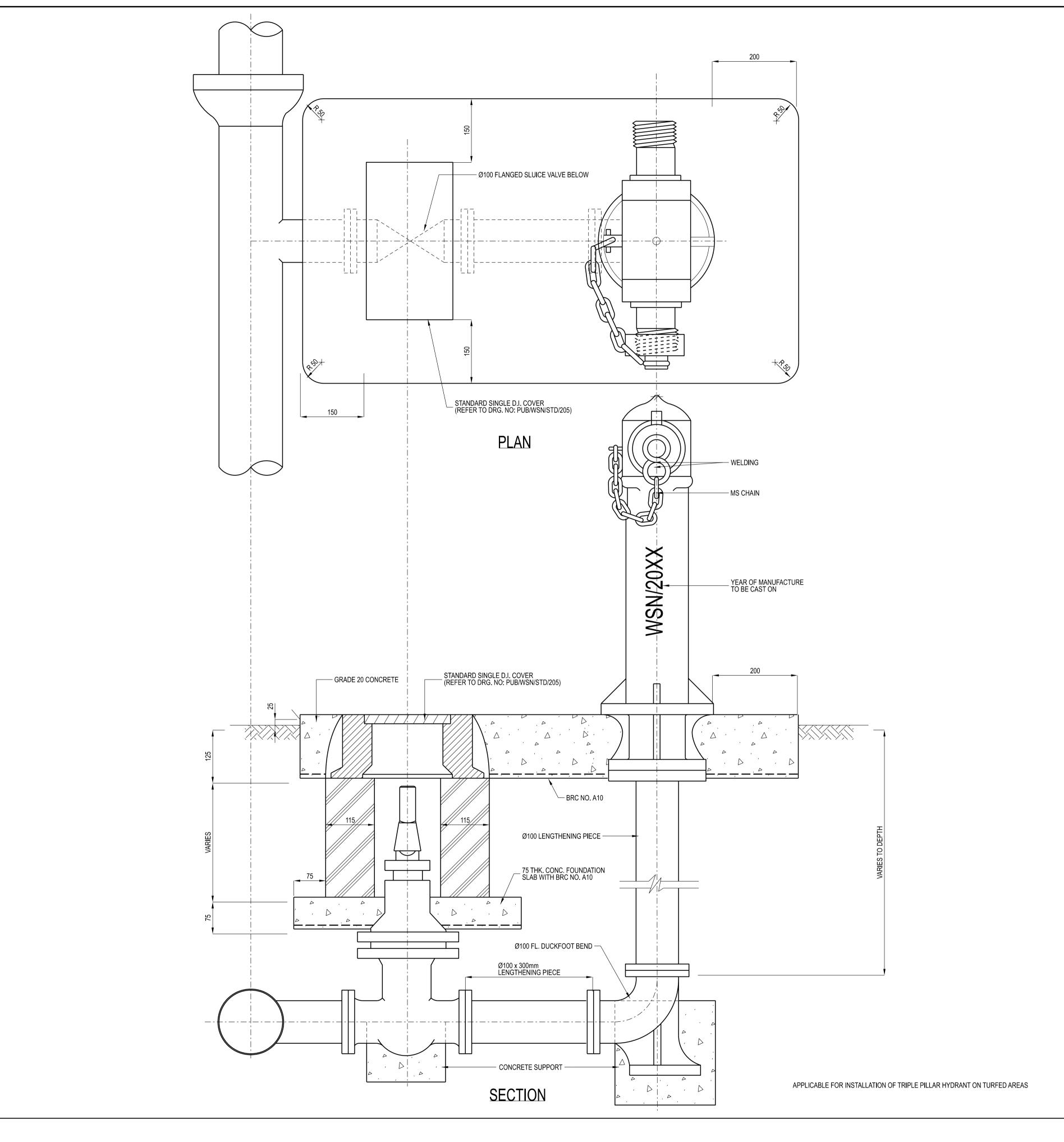
1) PIPE MUST BE DUCTILE IRON TO BS-EN 545
